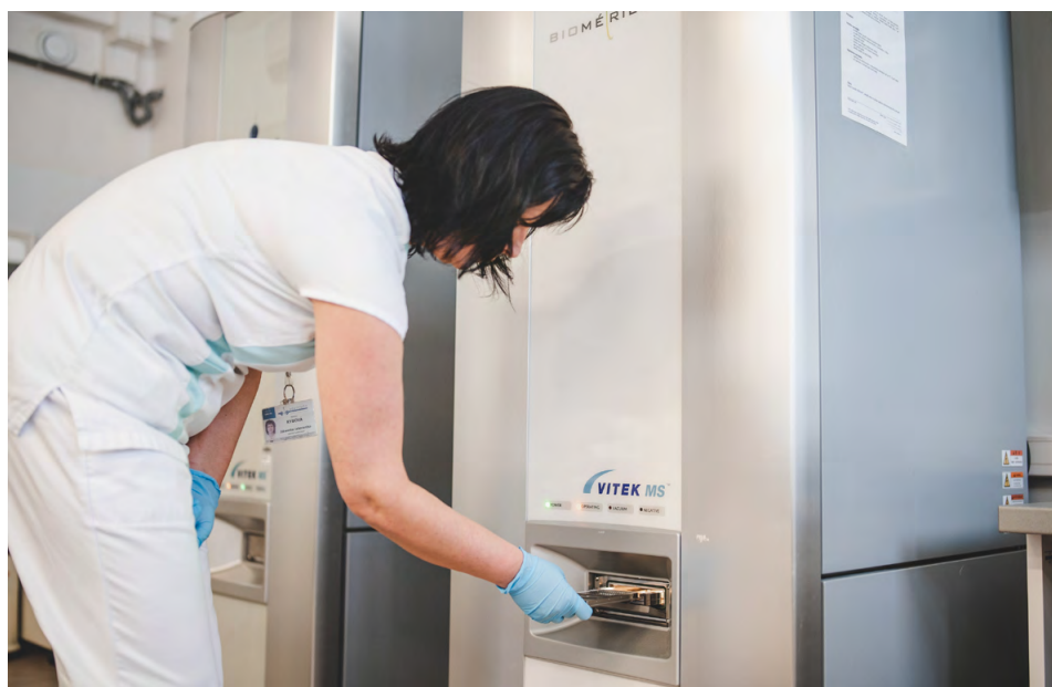
Laborantka Martina Rybová vkládá destičku s kulturami bakteriálních kmenů k identifikaci do přístroje VITEK MS / Foto: Jan Luxík
