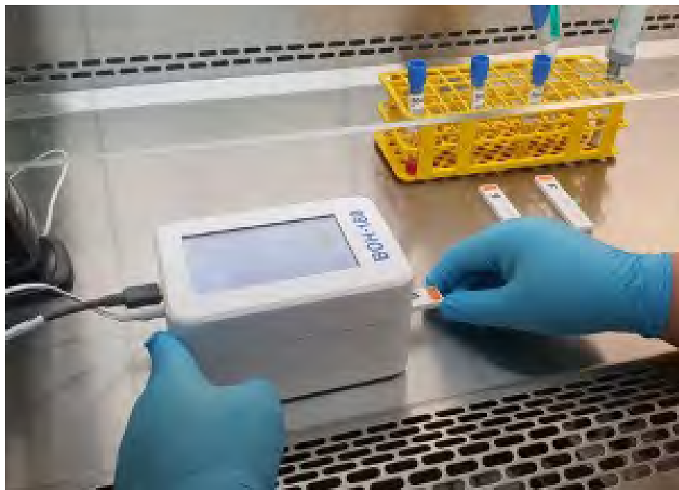
Kvantitativní stanovení N-antigenu SARS-COV-2 z krve. Měření výsledné hodnoty na testovacím proužku přístrojem / Foto: archiv laboratoře
