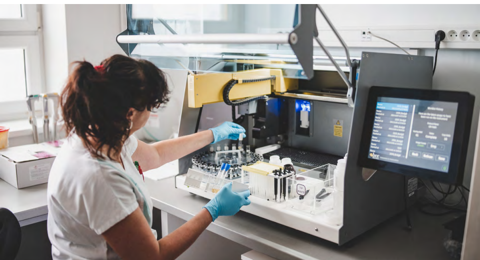
Laborantka Irena Vaněčková zakládá séra ke stanovení protilátek u lymfické boreliózy do automatizovaného přístroje Roboblot / Foto: Jan Luxík
