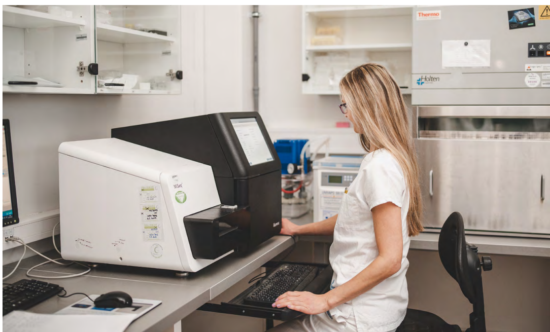
Sekvenátor pro masivně paralelní sekvenování / Foto: Jan Luxík
