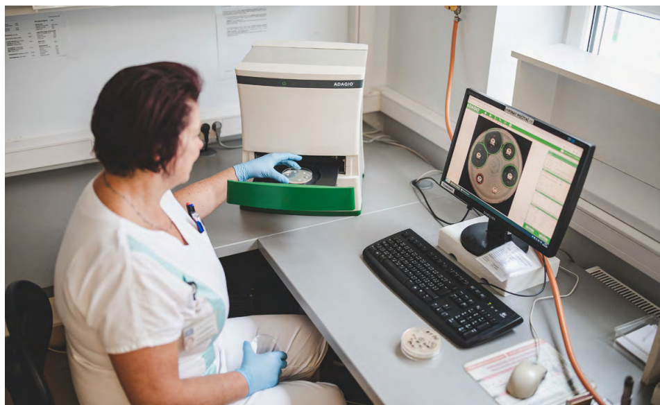
Laborantka Libuše Lagronová provádí měření výsledků kvalitativní citlivosti v systému Adagio / Foto: archiv laboratoře
