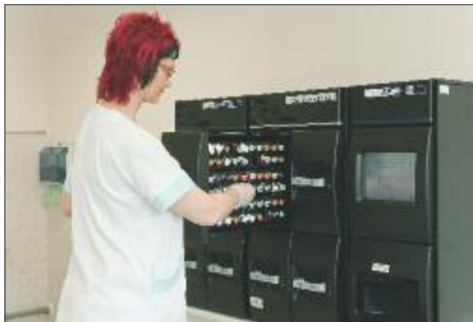
Hemokultivační přístroj pro diagnostiku infekcí krevního řečiště.
