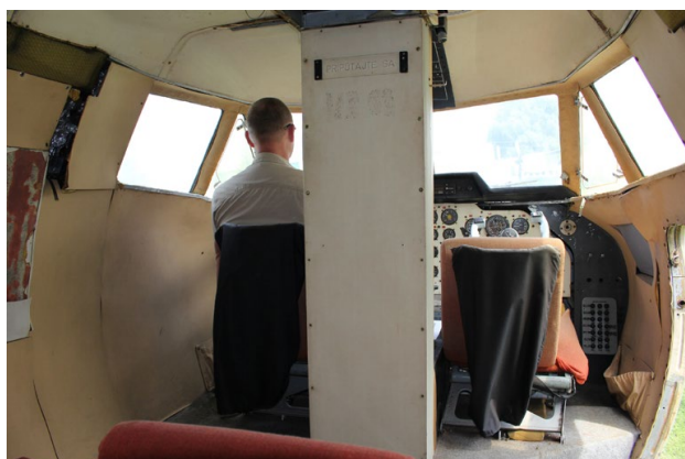
Obr. 1 Pohled na středový sloupek a kokpit L410
